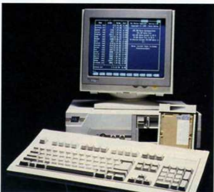
Die Festplatte des MTeC ist lediglich eingeschoben und läßt sich jederzeit aus dem PC entfernen
